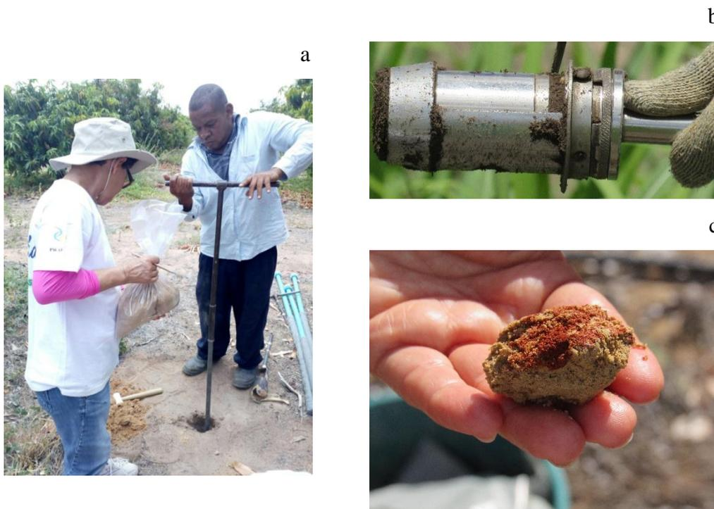
Figura 7. Procedimentos no campo para instalação dos poços de observação (PO) e amostragem de solo. a) tradagem para instalação dos poços b) coleta de amostras não deformadas c) identificação da presença de mosqueado.
