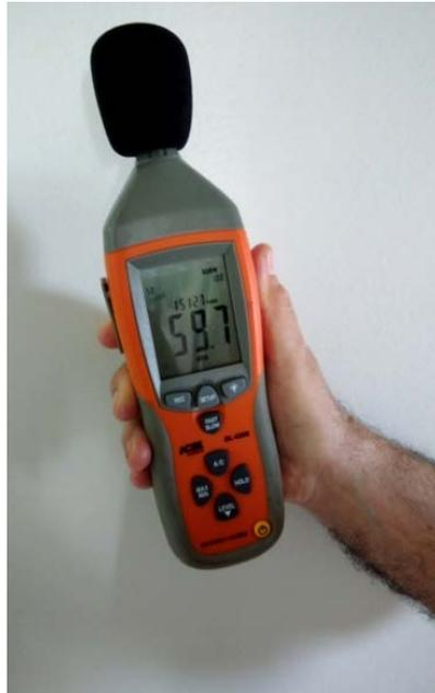
Figura 17 – Decibelímetro utilizado no registro do ruído na plataforma de trabalho (trator sem cabine) e no trator com cabine com ar condicionado
