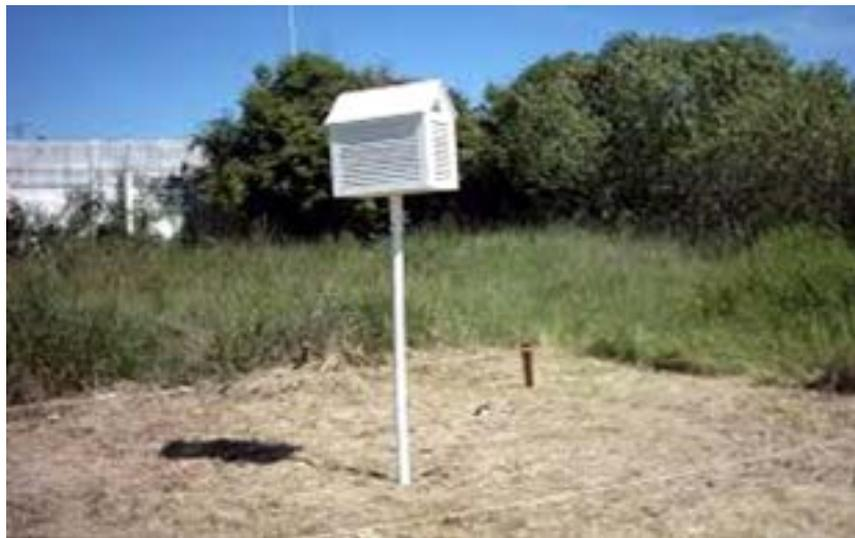
Figura 15 – Abrigo para “*datalogger*” utilizado na aferição das variáveis ambientais no campo.
