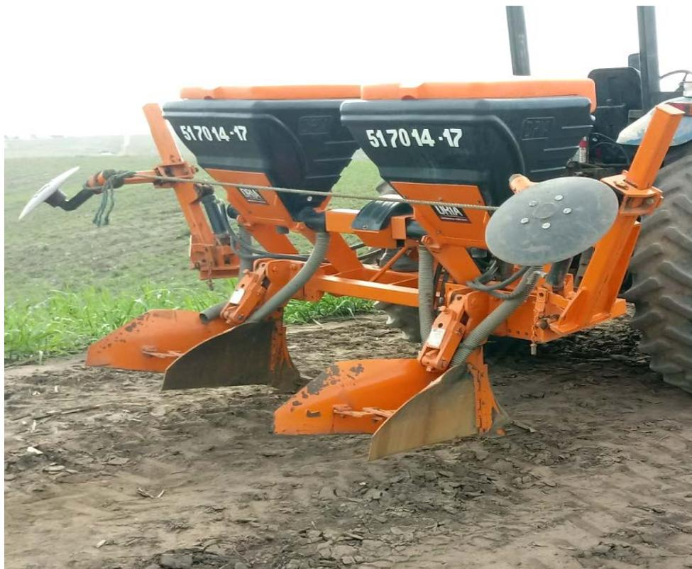
Figura 14 – Sulcador adubador tipo canavieiro de duas linhas usado nas áreas 01 e 02, durante a coleta de dados na operação de sulcagem
