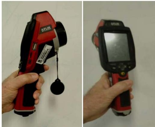
Figura 25 – Detalhes da câmera termográfica utilizada para registrar as imagens térmicas do operador durante as operações de campo
