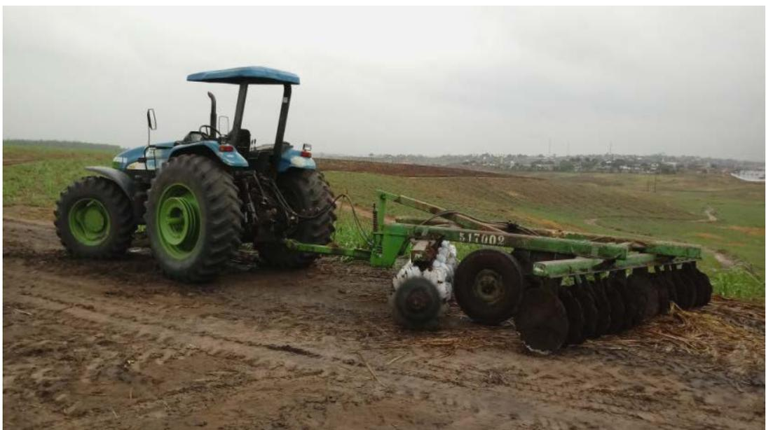
Figura 13 – Grade destorroadora/niveladora média utilizada nas áreas (01) e (02), durante a coleta de dados na operação de gradagem
