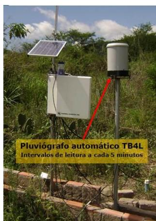
Figura 7. Pluviógrafo automático utilizado para registro da precipitação.
