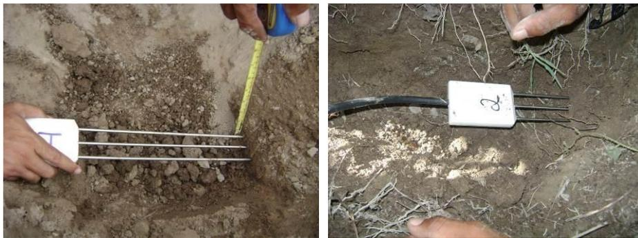
Figura 1. Instalação das sondas TDR's nas parcelas experimentais.
