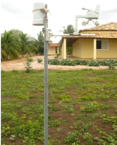
**Figura 1.** Estação meteorológica para obtenção dos parâmetros necessários para o cálculo da evapotranspiração.
