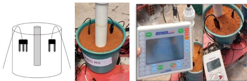
Figura 1. Posicionamento dos sensores ECH2O, modelos 5TE e EC-5, e do tubo de acesso da Diviner 2000 para monitoramento da umidade do solo nos vasos.
