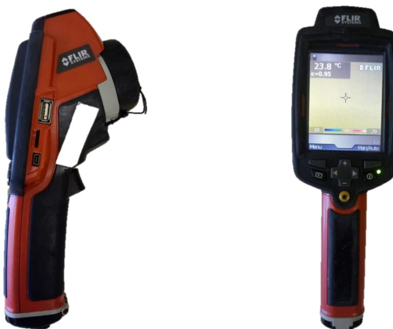
Figura 8: Câmera termográfica modelo FLIR I60. Fonte: Arquivo pessoal, 2019.
