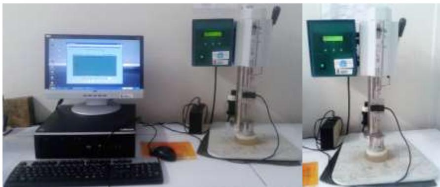
**Figura 8.** Penetrômetro de bancada. Laboratório de física do solo UFRPE
