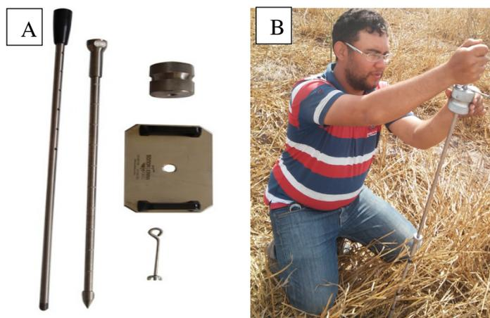
**Figura 4.** Penetrômetro de impacto reduzido (A); Realização do método, contagem do número de impactos (B).
