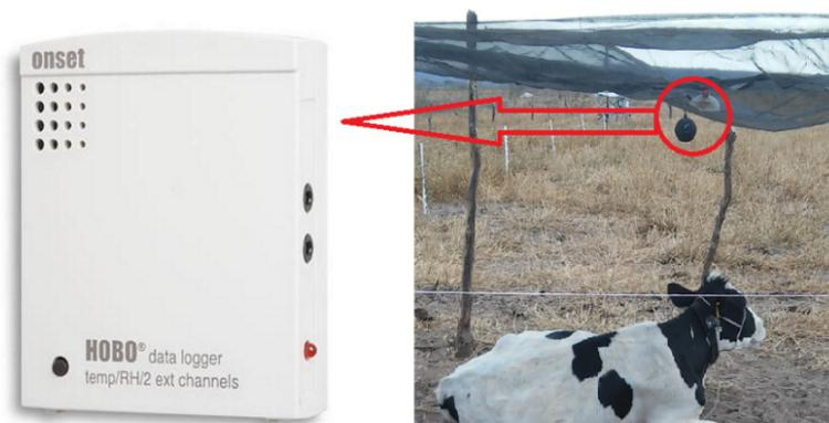
**Figura 2.** Datalogger utilizado para registro das variáveis ambientais (A); registradores instalados no interior da área de descanso (B).
