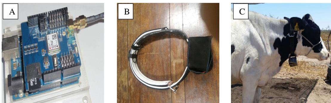
**Figura 5.** Hardware do sistema desenvolvido (A); protótipo experimental da coleira GPS (B); coleira GPS presa ao pescoço do animal (C).
