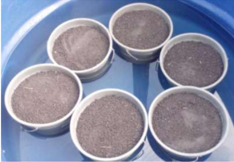
FIGURA 4 - Saturação do solo por elevação gradual.
