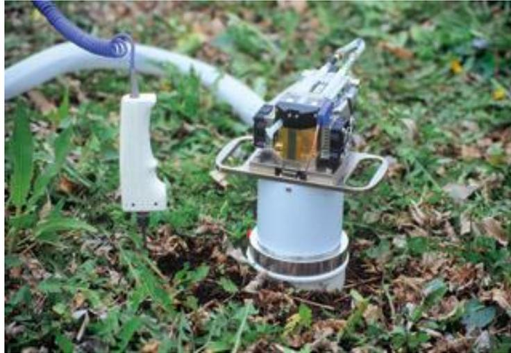
**Figura 3:** Câmara de efluxo de CO<sub>2</sub> (Modelo 6400-09). (Fonte: <https://www.licor.com>)
