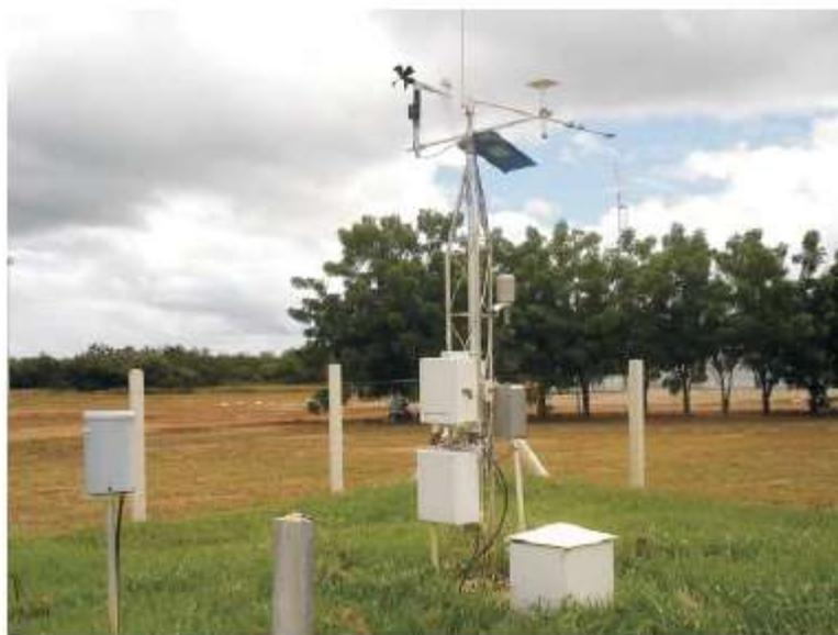
**Figura 04:** Estação Agrometeorológica Automática instalada na Fazenda Brasil Uvas, em Juazeiro – BA. **Fonte:** Embrapa Semiárido, 2015
