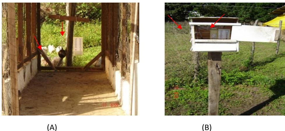
Figura 6 - Registro dos dados meteorológicos dentro do módulo de produção utilizando termo-higrômetro e termômetro de globo negro (A) e registro dos dados ambientais no ambiente externo (B).
