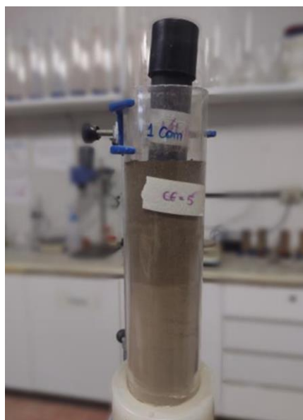
Figura 46 - Após 24 horas da última aplicação da solução, a coluna de solo foi umidificada com solução CE = 5 \text{ dS.m}^{-1} .
