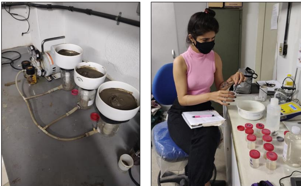
Figura 23 - Determinação da condutividade elétrica pelo método da pasta saturada do solo.
