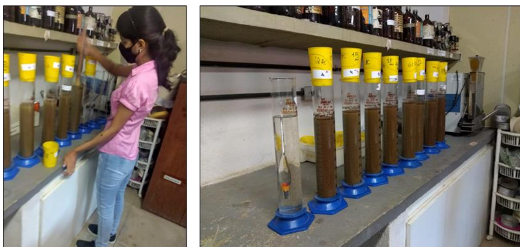
Figura 22 - Determinação da textura pelo método do densímetro de Boyoucus.
