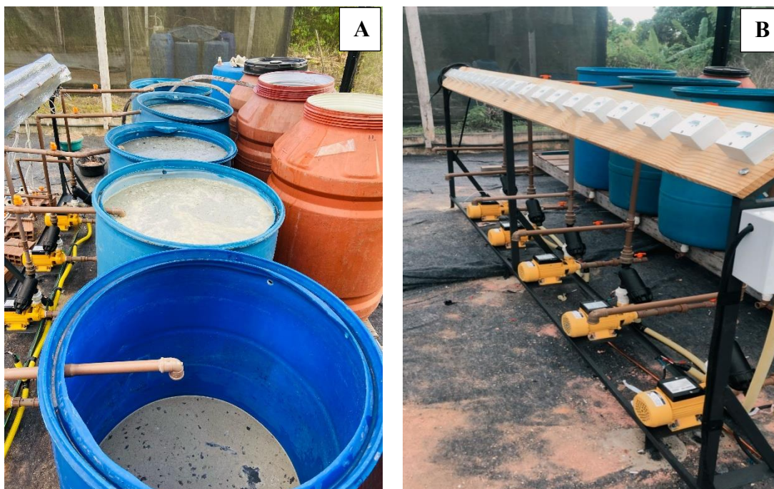
Figura 7: Níveis de diluição do esgoto doméstico tratado (A); Motobombas acopladas aos reservatórios dos níveis de diluição (B).
