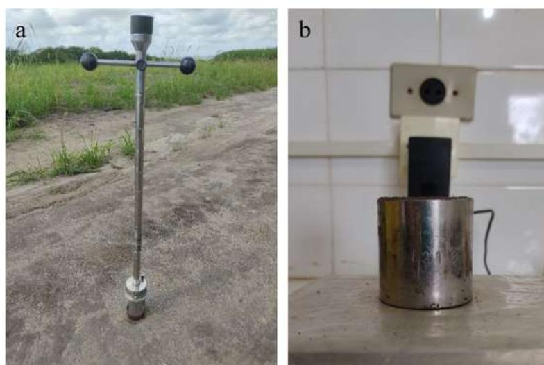
**Figura 9.** Amostrador Uhland (a) e anel volumétrico (b).
