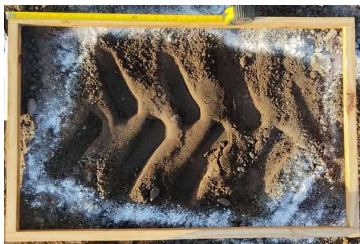
**Figura 11.** Área fotografada superfície de contato pneu-solo dentro do quadro utilizado para delimitação experimental da área.
