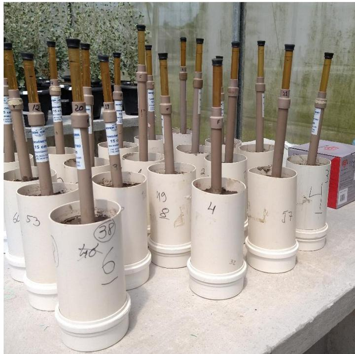
**Figura 3.** Colunas de solo com tensiômetros instalados.
