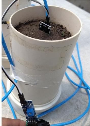
**Figura 2.** Coluna de solo com sensor YL-69 instalado.
