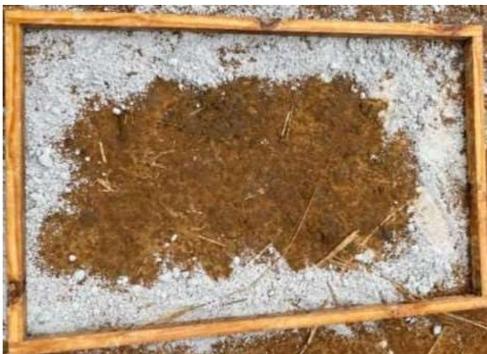
**Figura 3** - Área fotografada superfície de contato pneu-solo dentro do quadro utilizado para delimitação experimental da área.
