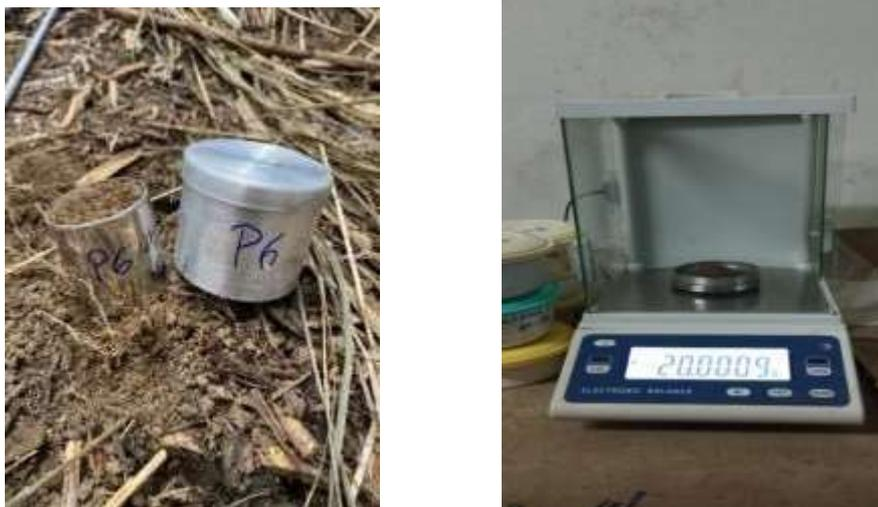
**Figura 2** - Amostras de solo coletadas à campo e pesagem no laboratório
