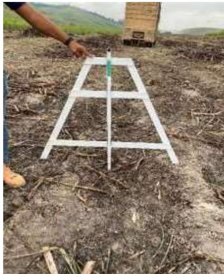
**Figura 4** - Medição da deformação do solo utilizando a metodologia da flecha.
